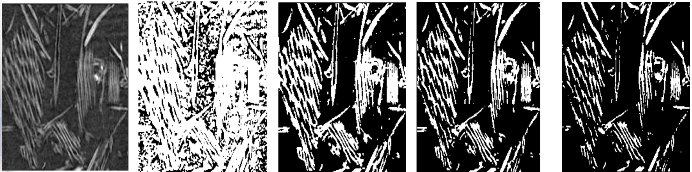
IFB60HR: a) image initial et image segmente avec la valeur de seuillage b) s=41 c) s=70 d) s=85 e) s=99
