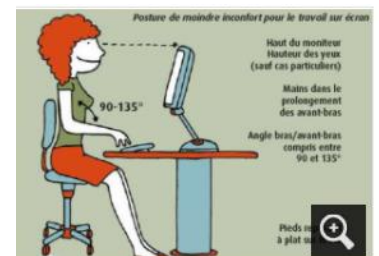
Posture de moindre inconfort pour le travail sur écran
