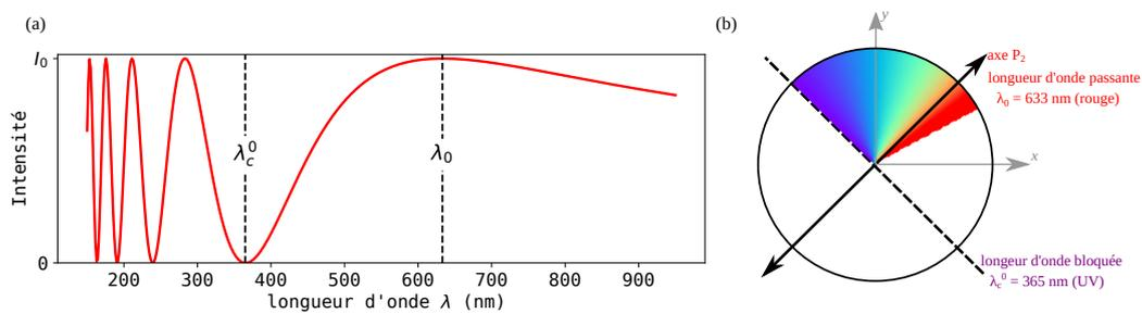
Figure 4: (a) Spectre transmis à travers la lame de quartz, mettant en évidence la présence de cannelures (extinction de certaines longueurs d'onde). (b) Représentation schématisique de la rotation de polarisation pour chaque longueur d'onde à travers la lame de quartz. Le polariseur  $P_2$  sélectionne la longueur d'onde  $\lambda_0$  et bloque complètement la longueur d'onde 365 nm dans l'UV.
