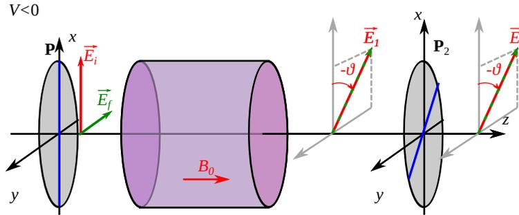
Figure 3: Isolateur optique Faraday. Sur le schéma  $V < 0$ . En rouge la polarisation de l'onde incidente, en vert la polarisation de l'onde réfléchie. L'épaisseur du cristal et le champ  $B_0$  sont choisis pour obtenir  $-\theta = -45^\circ$ .
