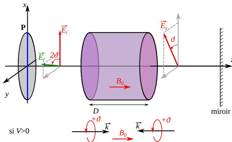
Figure 2: Effet Faraday. Attention, tous les angles sont représentés pour une constante de Verdet  $V > 0$ .  $\vec{E}_i$  représente la polarisation de l'onde incidente,  $\vec{E}_s$  celle de l'onde après passage dans le cristal,  $\vec{E}_f$  celle de l'onde après réflexion sur le miroir et un aller-retour dans le cristal.
