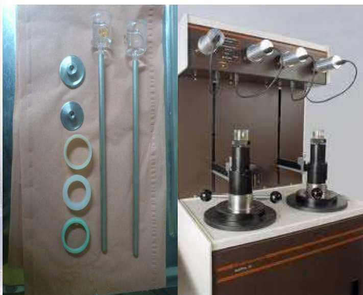
La porosimétrie au mercure (Micromeritics-Autopore III 9420)
