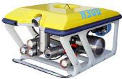
Robot imageur sous- marin - 1 à 1000 atm
