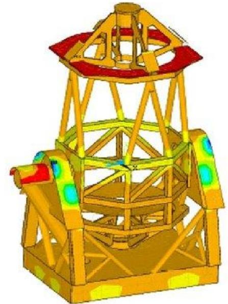
Gradients sur structure télescope
