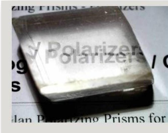
Photographie illustrant le phénomène de double réfraction par un cristal naturel de calcite.
