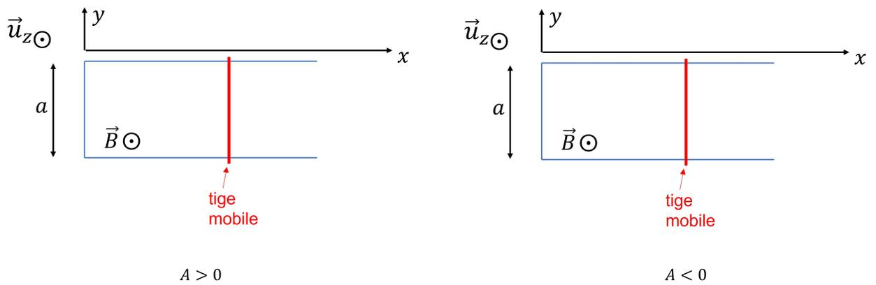
FIGURE 2 – Courant et champ induits, force de Laplace
